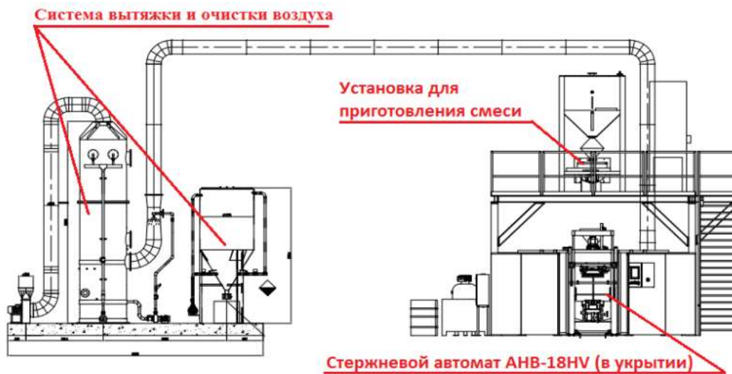
Рисунок 1.7 - Технологічна схема вузла автомата для виготовлення стрижнів
